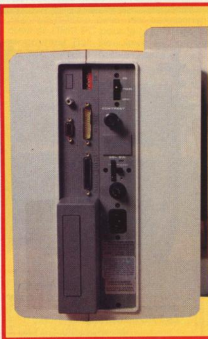
◀ A l'arrière du Tele PC se trouvent toutes les interfaces utiles : parallèle, RS 232C, connecteur pour moniteur couleurs extérieur. ▼ Le Tele PC de Televideo.
